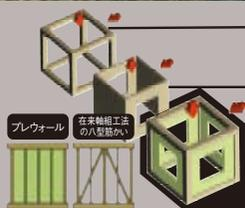
在来軸組工法…間取りの構成は比較的自由に行えますが、外からの力に対して柱や筋かい、梁だけで支える構造なので、部材が細かい場合やバランスが悪い場合は、一カ所に大きな力が働き大きく変形する傾向があります。
